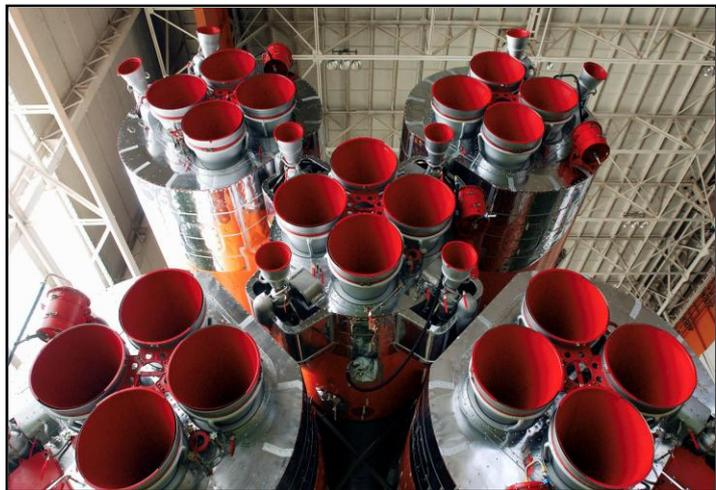
*Les moteurs de la fusée R-7 entourés par les petits moteurs destinés à l'orientation. Source : RKK Energia*
